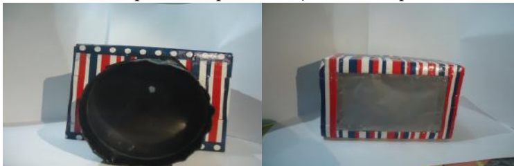
Figura 2. Câmera escura produzido para utilização nas aulas práticas em sala de aula
